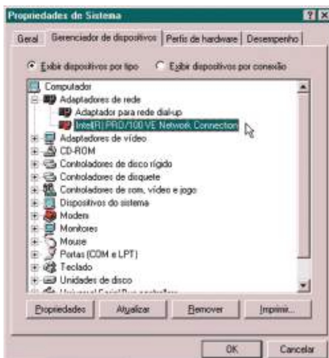
Figura 75: Placa de rede com problemas.
