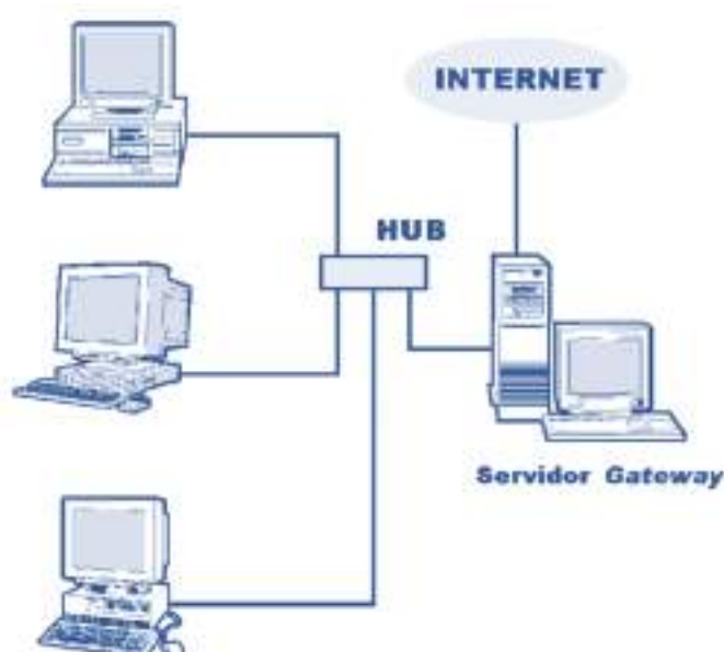
Figura 15: Partilha de conexão com a Internet numa pequena rede de 4 computadores.
