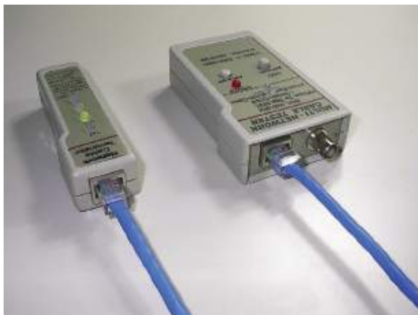
Figura 38: Teste de um cabo com dois conectores RJ-45.
