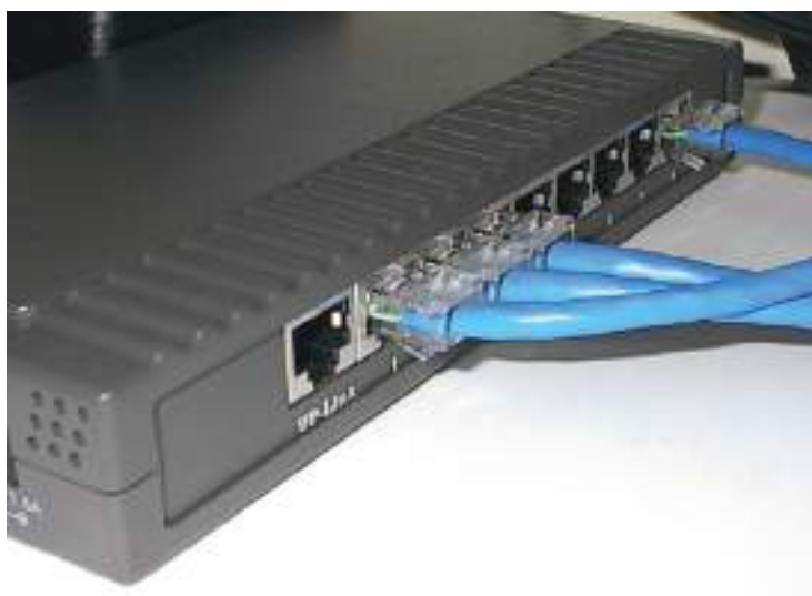
Figura 32: Detalhe da conexão dos cabos no hub.
