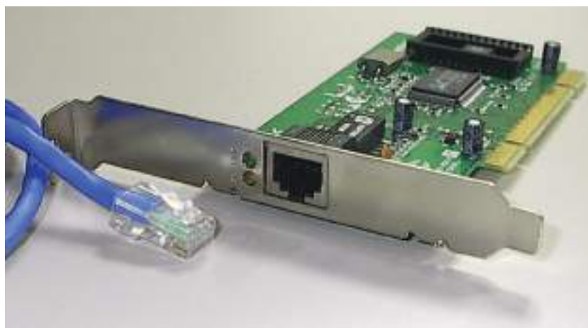
Figura 21: Conectores RJ-45 no cabo e na placa de rede
