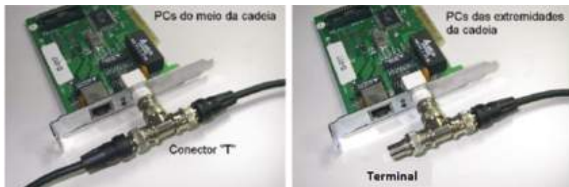
Figura 25: Conexões de cabos Thin Ethernet na placa de rede utilizando conectores “T” e terminais.
