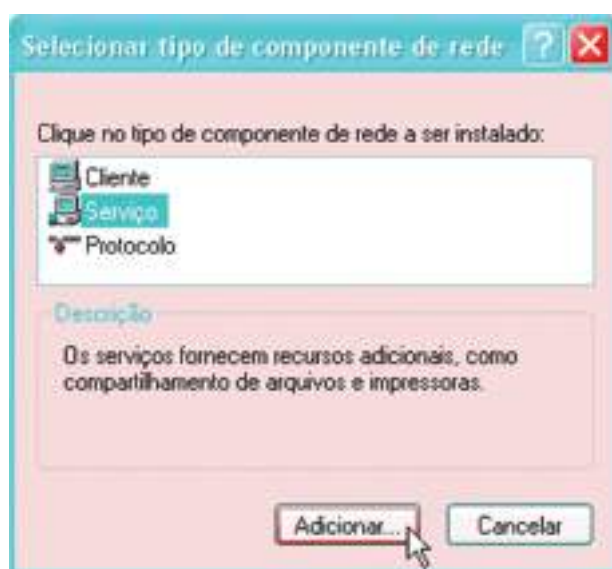
Figura 80: Para instalar um serviço.
