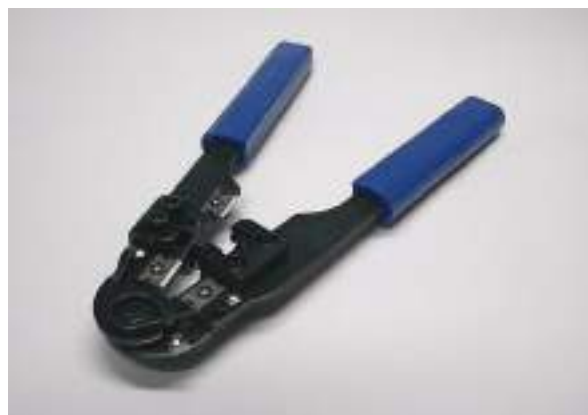
Figura 33: Alicate para fixação de conectores RJ-45.
